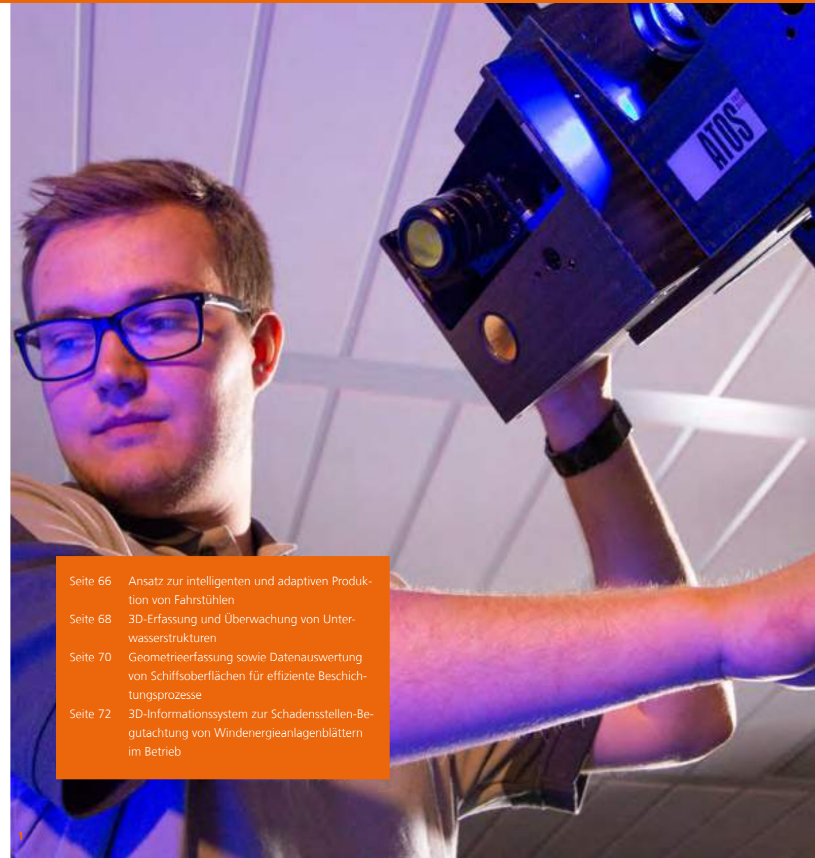
1 Lars Bretthauer bei der Vermessung mit Hilfe eines Streifenlichtprojektors
